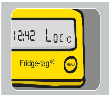
Дисплей отображает слово **Loc 10 минут**, в течение которых фридж-тэг не измеряет температуру, чтобы избежать ложных значений при считывании.
